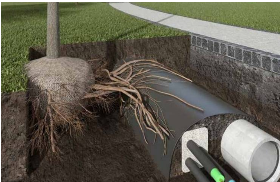
Shematski prikaz korijenske barijere—RootControl® (Greenmax).
