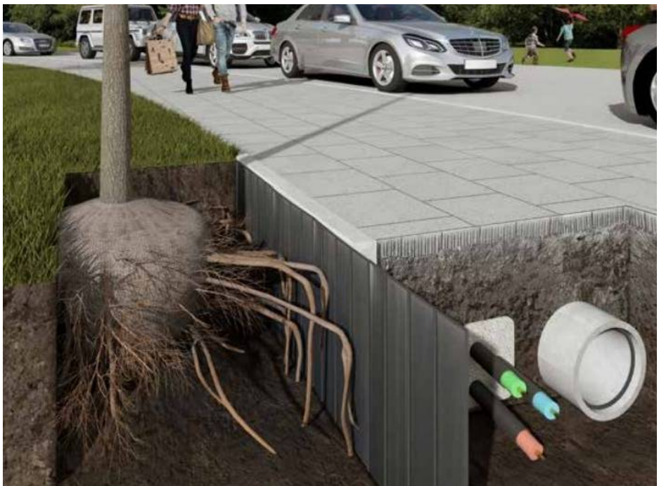
Shematski prikaz korijenske vodilice—GreenMax Tree Root Guide (Greenmax).
